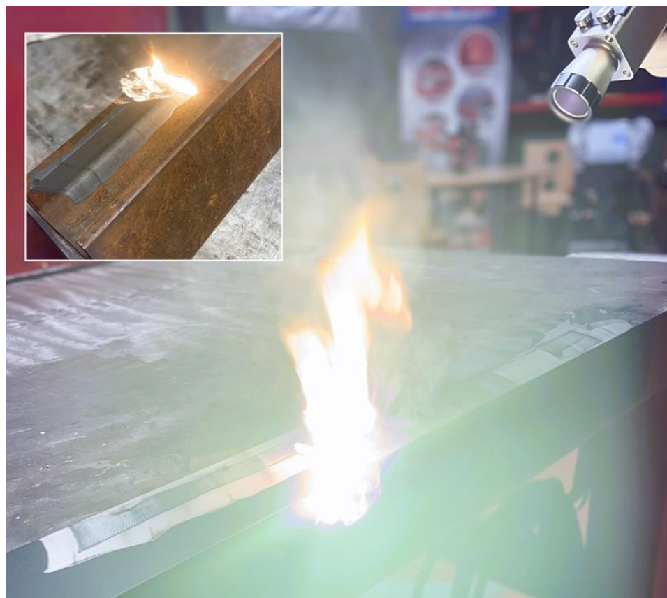
Het is nu ook mogelijk om met het Fanuci handbediend lastoestel te lasersnijden en lasercleanen (foto)
